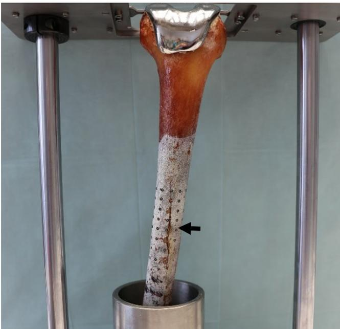
Abb. 46: Präparat Standard5 in der Einbettvorrichtung: Beispiel für eine 7 cm lange, anteriore Längsfraktur, ausgelöst durch die Implantation.
