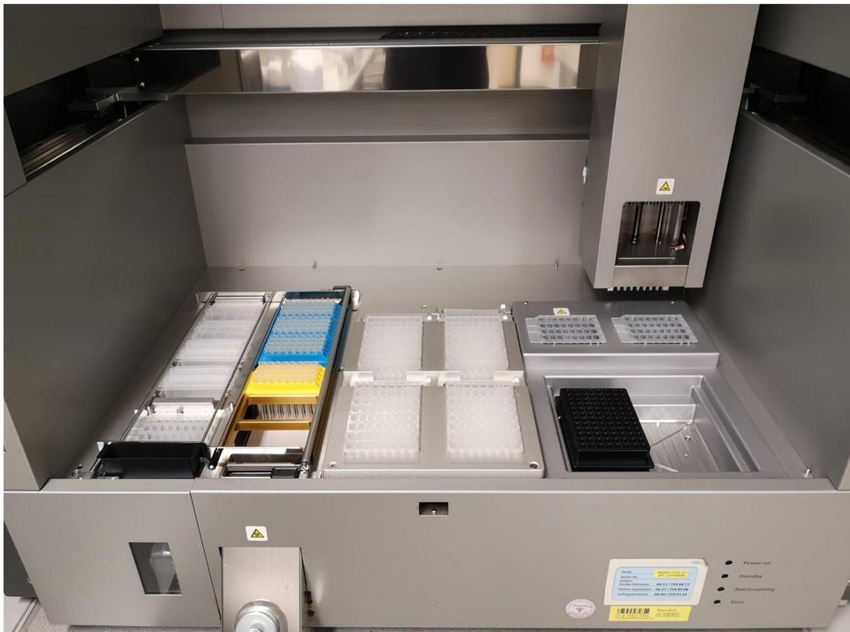
Abbildung 8: MagNA Pure LC, Plattform mit positionierten Pipettenspitzen und Einweg-Kunststoffbehältnissen und robotischem Arm (rechts hinten)
