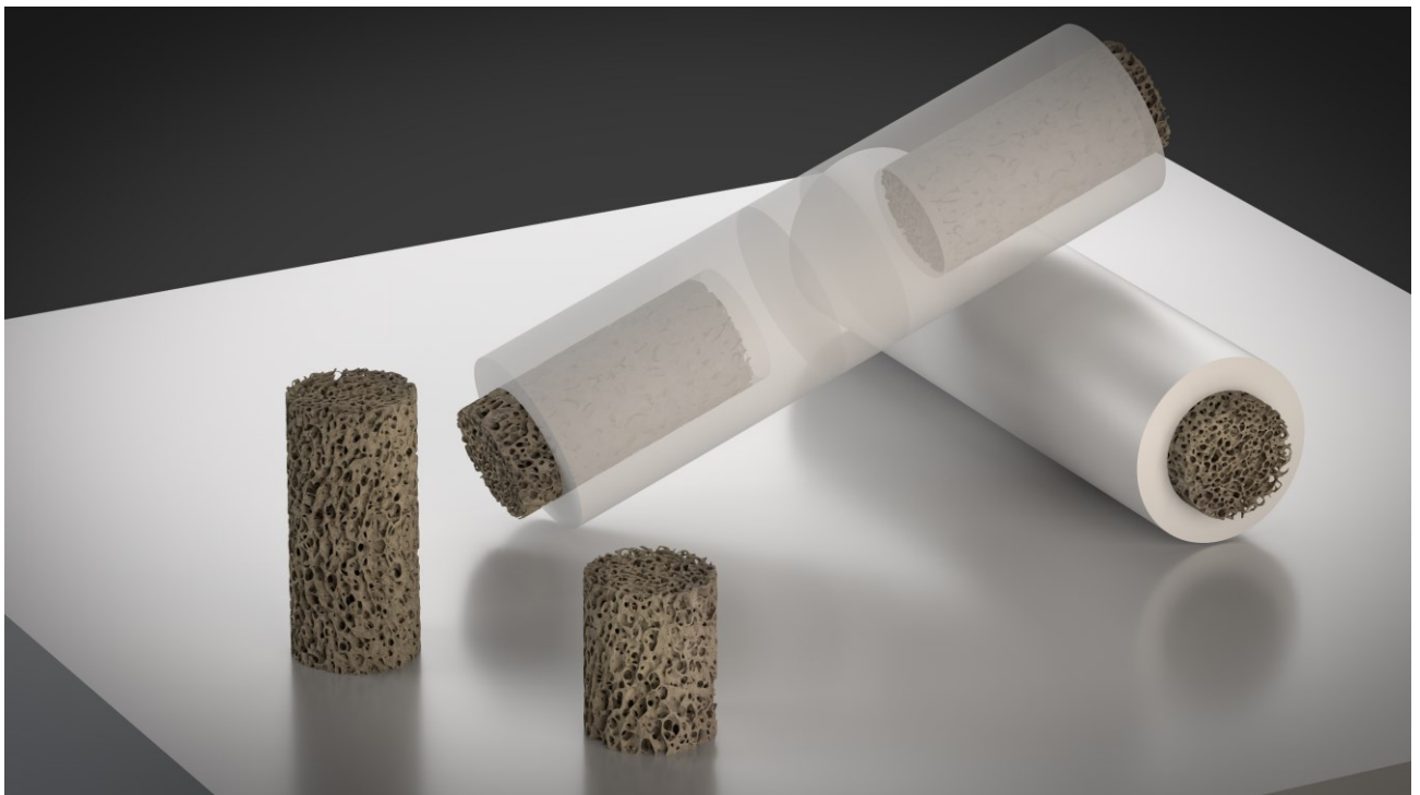
Abbildung 2.5 zeigt eine grafische Darstellung mit Knochenprobe in POM Fixiermaterial
