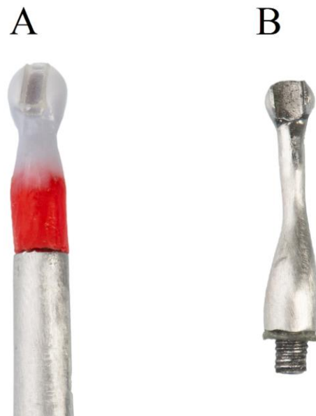
Abbildung 37: A: Modellierung des Applikatorkopfes aus Pattern Resin und Wachs auf Mundspiegelhalterung; B: Fertiger Applikatorkopf mit Gewinde aus Remanium 2000.
