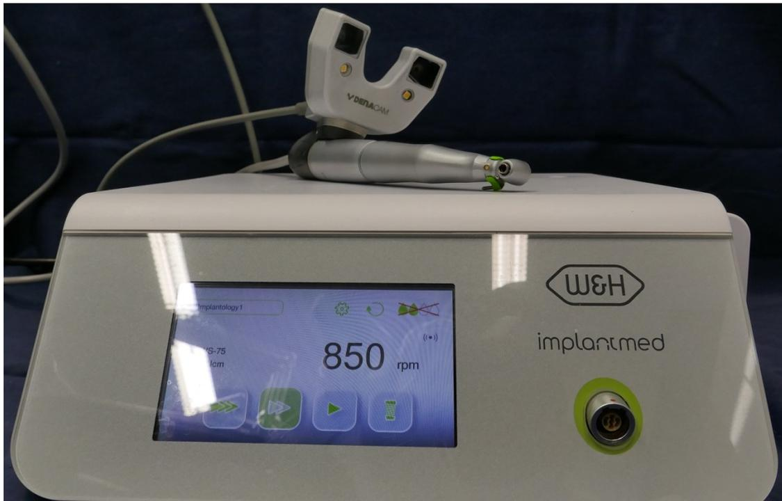
Abbildung 22. Der verwendete chirurgische Motor mit entsprechendem Handstück, welches mit dem Denacam System verbunden wird.
