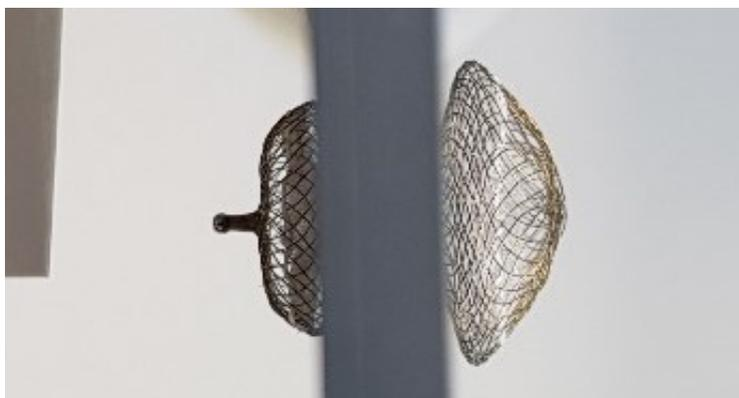
**Abbildung 67: Verformung von kleinen Occludergrößen am dicken Septum**
