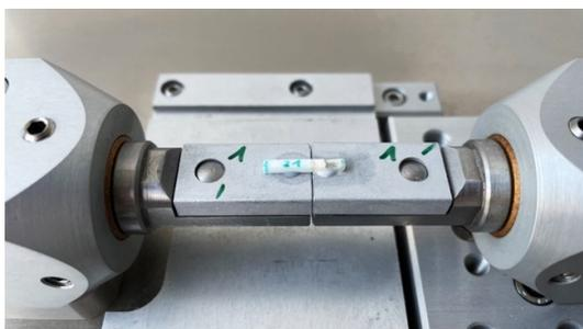
(a) Prüfkörper vor dem Start des Zugversuchs
