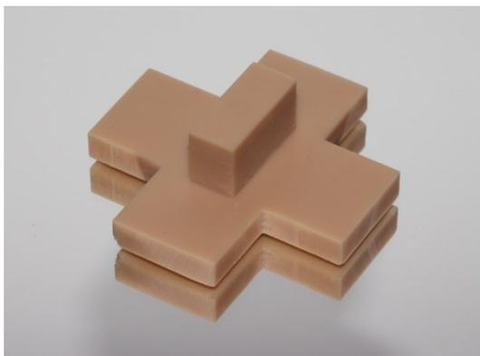
(a) 3D-gedruckter Prüfkörperhalter
