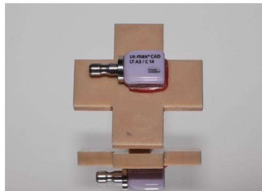
(b) Befestigung des Blocks auf dem Prüfkörperhalter
