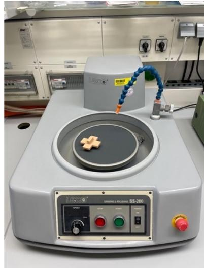
(b) Leco SS-200 Nassschleif- und Poliersystem mit 600-grit Schleifpapier
