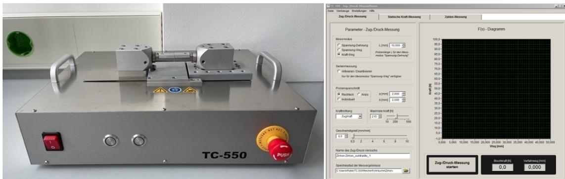
**Abbildung 21** Mikrozugmaschine (links) mit zugehöriger Software (rechts)
