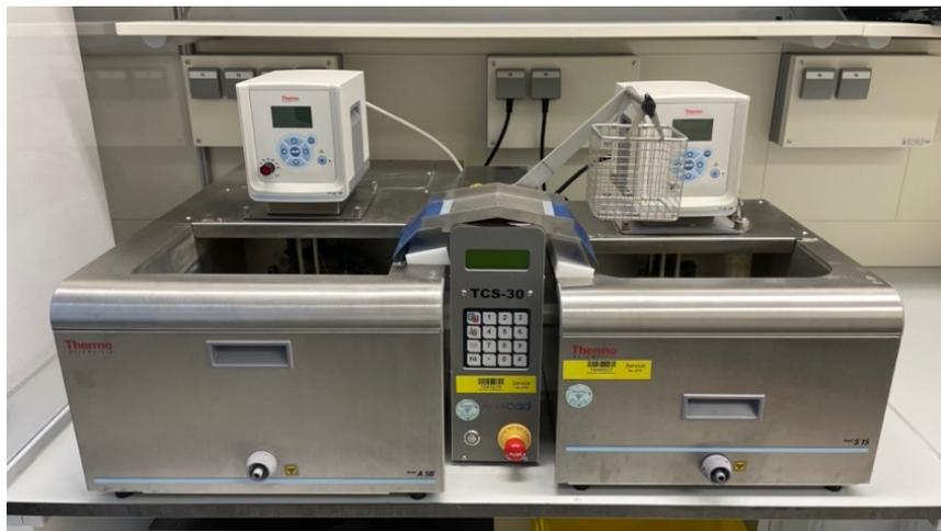
**Abbildung 20** Thermowechselbad
