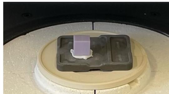
(b) Geschliffener Prüfkörper vor dem Kristallisationsbrand
