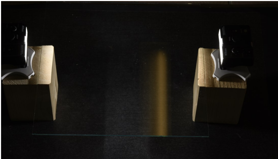
Abbildung 17: Glasplatte auf zwei Holzblöcken mit jeweils einem Makroblitz gegenüberliegend
