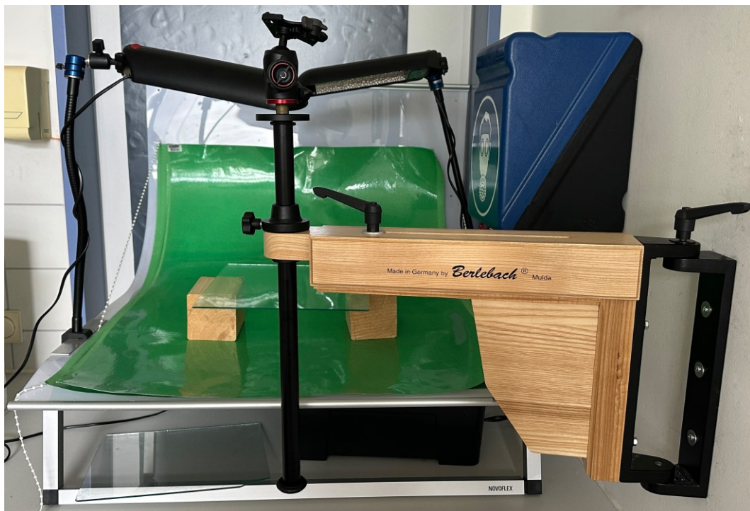
Abbildung 15: Arbeitsplatz in der Sektionshalle mit Auflichtplatte mit zwei schwenkbaren Halogenlampen und einem Wandstativ
