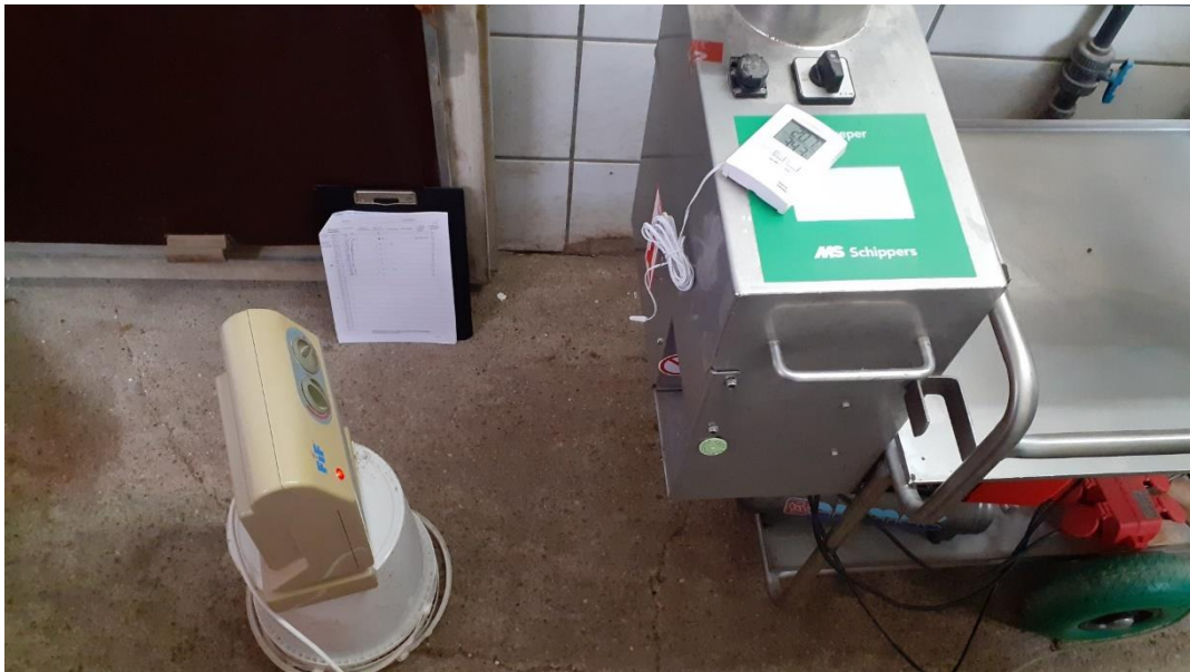
Abbildung 6: Heizlüfter vor der Verdampfereinheit des Narkosegerätes MS Pigsleeper als externe Wärmequelle.
