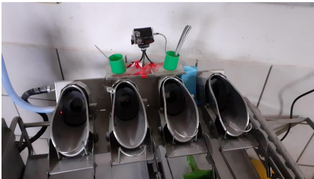
Abbildung 2: Foto von den vier Kastrationsmasken des MS Pigsleeper und der zentral positionierten Kamera zur Aufnahme des Kastrationsprozesses.
