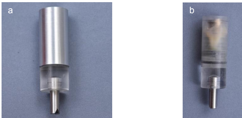
Abbildung 11 Probenhalter; a) Probenhalter mit Deckel; b) Probenhalter ohne Deckel
