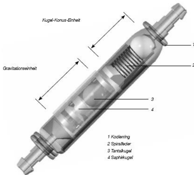
Abb. 5: Darstellung des PaediGAV im Querschnitt. Modifiziert nach CHRISTOPH MIETHKE GMBH & CO. KG. paediGAV Gebrauchsanweisung.GBA_04_15_0518
