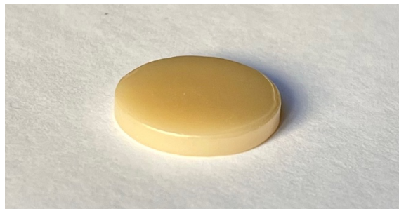
Abbildung 13: Exemplarische Darstellung eines Prüfkörpers, d=1,5\text{cm} , h=2,0\text{mm}
