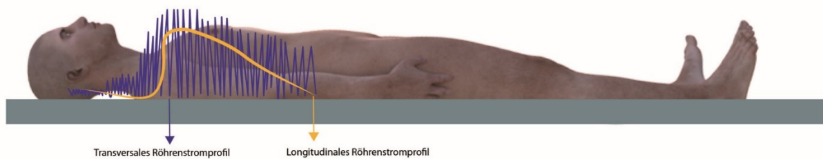
Abb. 2.10: Prinzip der angular-axialen Röhrenstrommodulation (© Regine Kuschke 2015, www.de-sein.com , nach einer Vorlage von M. Seidenbusch [76]). Die gelbe Kurve entspricht dem axialen bzw. longitudinalen, die blaue Kurve dem angular-axialen bzw. transversalen Röhrenstromprofil.
