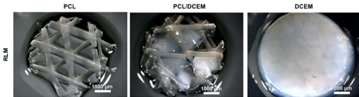
Abbildung 6 zeigt in der Auflichtmikroskopie die grobe Morphologie der drei Scaffold-Typen. PCL = Polykaprolakton, DCEM = DPNC. Balken = 1000 µm.[45]
