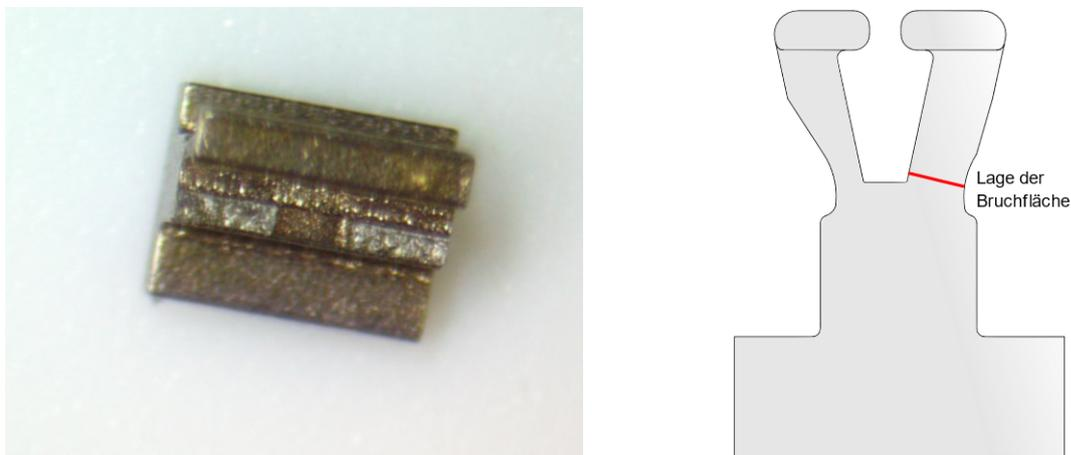
Abbildung 57: Lichtmikroskopische Aufnahme eines im Ermüdungsversuch gebrochenen Bracket-Flügels (links, Revisionsstand 18 nach ca. 4.560 Zyklen) und Skizze zur Darstellung der Lage und Richtung der Bruchfläche.
