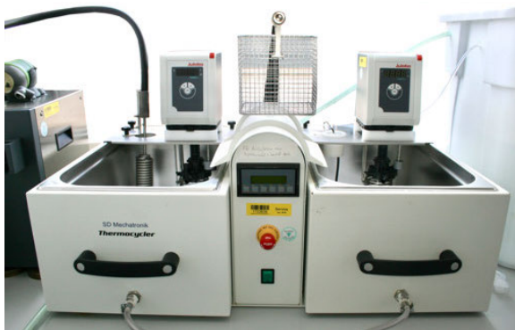
Abbildung 17: Thermolastwechsler THE 1100, SD Mechatronik GmbH
