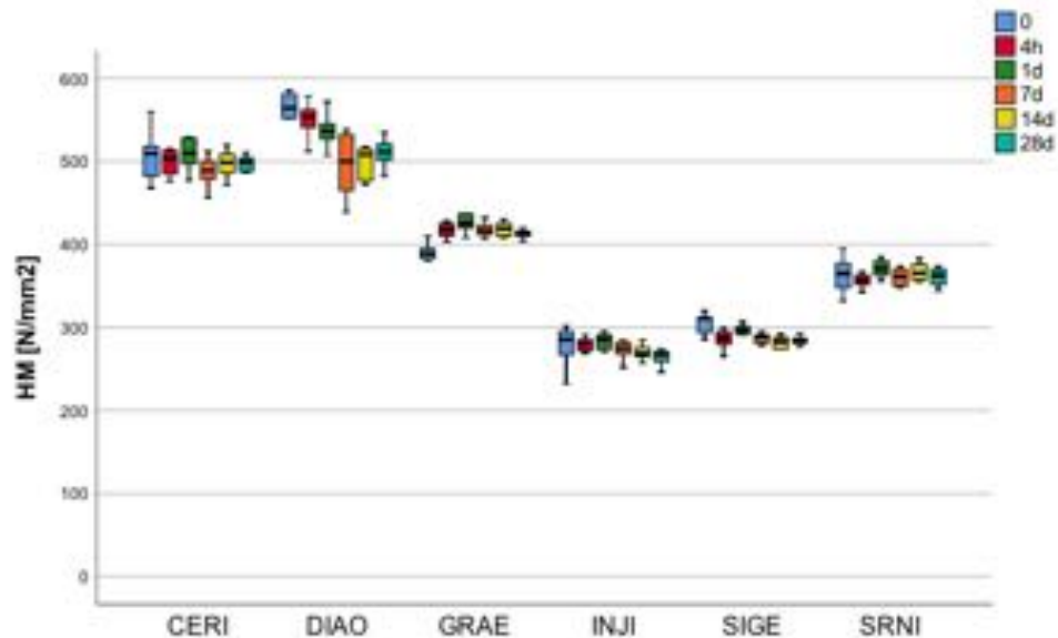
Abbildung 45: Martenshärten in N/mm 2 der Schneidmassen zu den verschiedenen Alterungszeitpunkten
