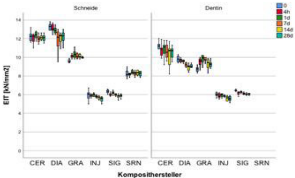
Abbildung 54: Elastisches Eindringmodul aller Verblendkomposite zu den verschiedenen Alterungszeiten. Getrennt nach Schneide- und Dentinmasse
