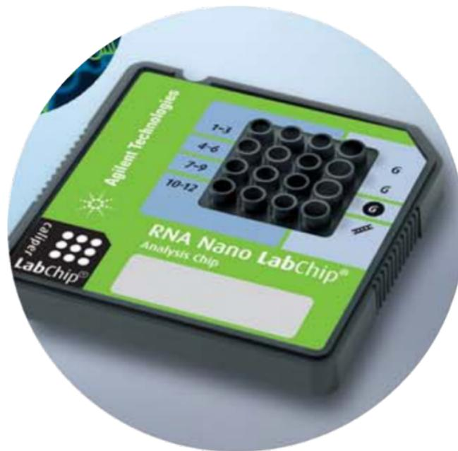
**Abb. 3-2 Agilent RNA 6000 Nano Chip.** Es sind insgesamt 16 Reaktionsgefäße in einem Chip verfügbar, von denen 12 Reaktionsgefäße für Probenanalyse vorgesehen sind. In vier Reaktionsgefäßen werden der Gel-Farbstoff-Mix sowie der Leiter zugesetzt (siehe Markierung auf dem Chip). *Abbildung aus Agilent RNA 6000 Nano Kit Guide.*
