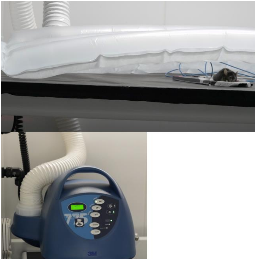
Abbildung 13: Aufbau Temperaturmanagementsystem (=TMS) der Gruppe 6 (unter dem Untersuchungstisch positionierte Wärmeeinheit leitet warmen Luftstrom durch Schlauch in Wärmedecke, welche Untersuchungstisch und Maus bedeckt)
