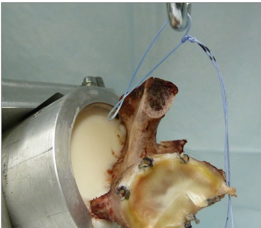
Abbildung 21: Versagen durch Ausriss des Fadens aus dem Ankerkörper
