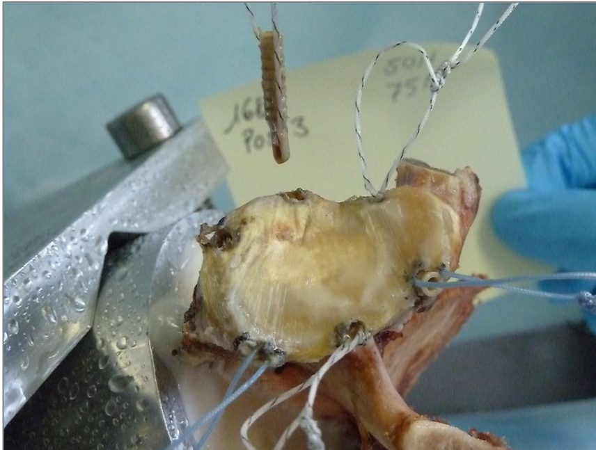
Abbildung 20: Versagen durch Ausriss des Ankers aus dem Glenoid
