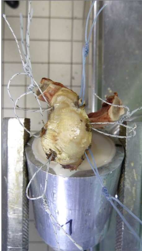
Abbildung 14: Glenoid mit sechs primär implantierten Fadenankern
