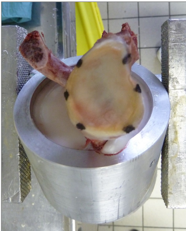
Abbildung 13: Glenoid in Aluminiumzylinder mit Markierung der Ankerimplantationsstellen
