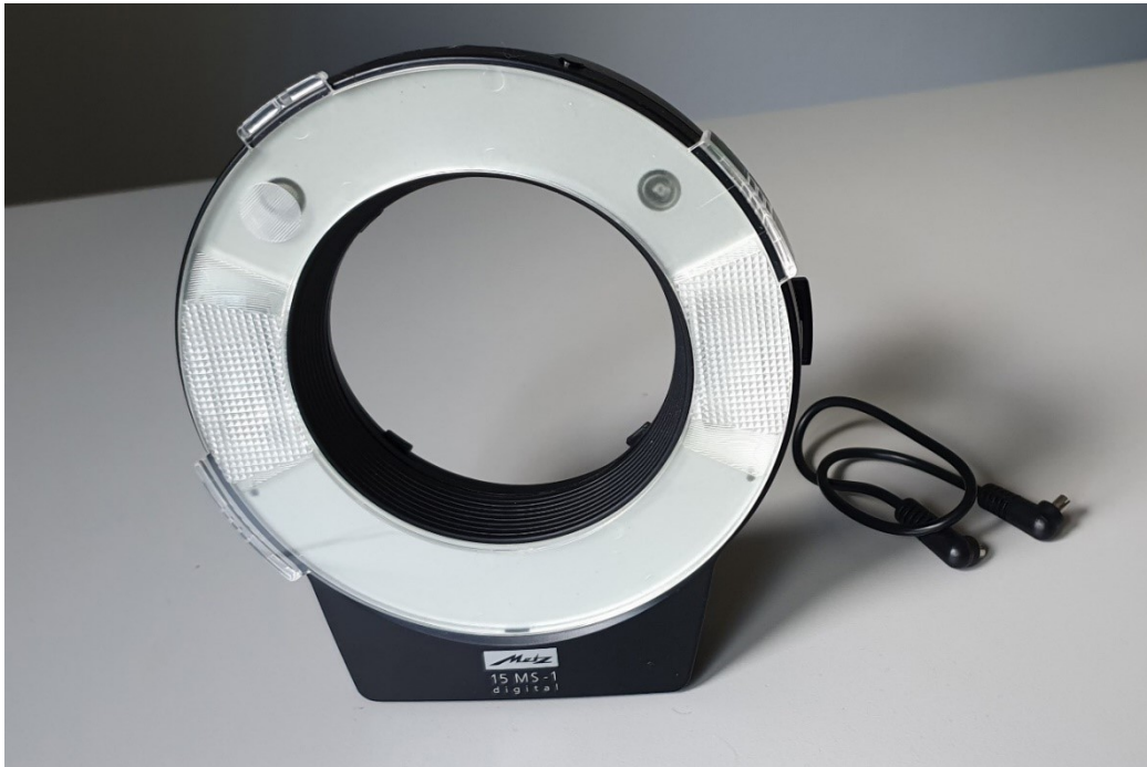
Abbildung 8: Der „Metz Mecablitz 15 MS-1 digital“ mit Anschlusskabel zur Verbindung mit der Kamera (Svenja Maier, 2022)
