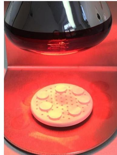
Abbildung 20: LV Prüfkörper unter Trockenlampe
