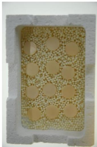
Abbildung 21: Sinterschale mit fertigen LV Prüfkörpern
