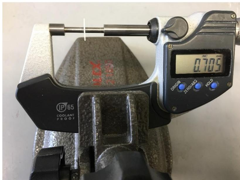
Abbildung 23: Mikrometerschraube zum Vermessen der Prüfkörper
