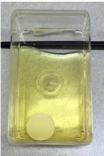
Abbildung 19: LV Prüfkörper in der Färbelösung
