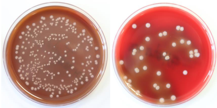
Abbildung 14: Zwei Unterschiedliche Verdünnungsstufen nach dem Ausplattieren bereit zur Auszählung der CFU's
