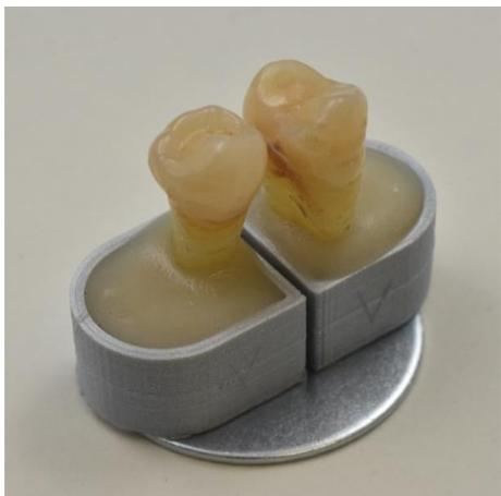
Abbildung 4: Fertiggestelltes, einpolymerisiertes Probenpaar mit Approximalkontakt
