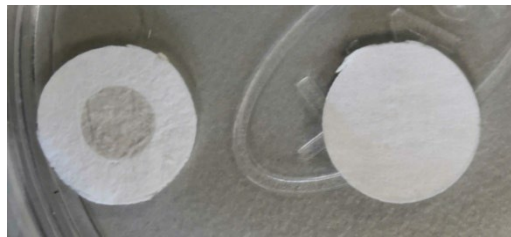
Abbildung 30: Filter des PSAPs vom 28.03.2018 während EMeRGe-Asien. Links der Filter mit der Ablagerung des Aerosols und rechts der Referenzfilter.
