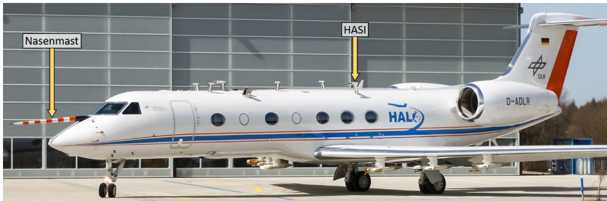
Abbildung 10: HALO mit seinen diversen Außenkonfigurationen. Speziell gekennzeichnet sind hierbei der Nasenmast und der HASI Einlass (HALO-SPP 1294). Ebenfalls zu erkennen sind die verschiedenen Einlässe für die Spurengasmessungen und die Flügelstationen, wobei letztere bei EMERGe nicht im Einsatz waren.
