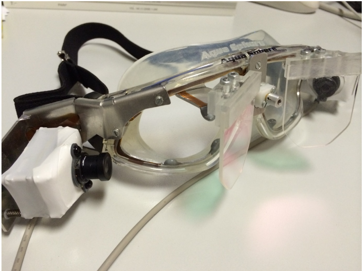
Abbildung 3: EyeSeeCam mit seitlich angebrachten Infrarotkameras, die über die Spiegel die Pupillen filmen
