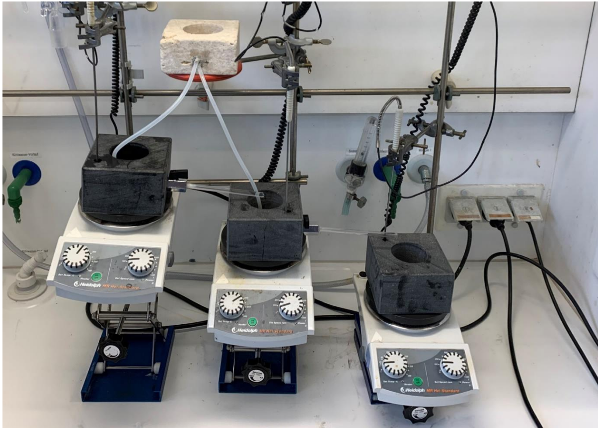
Abbildung 16: Bild des Aufbaus der drei notwendigen Gesteinsreaktoren und wie sie nacheinander platziert wurden. Der Travertinreaktor mit den zwei nach unten führenden Schläuchen dient der Zugabe von Flüssigkeiten in die ersten beiden Reaktoren.
