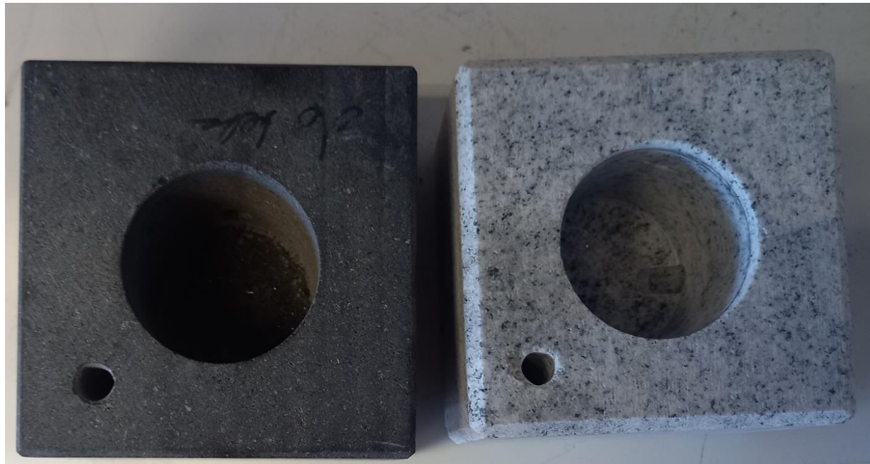
Abbildung 2: Bild der Gesteinsreaktoren aus Basalt (links) und aus Gneiss (rechts) mit Reaktionsmulden.
