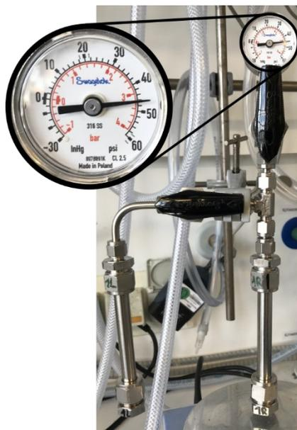
**Abbildung 52:** Druckmessung bei Raumtemperatur in einer der Edelstahlapparaturen, die mit 3.7 g Schwefeldioxid befüllt ist ( $p = 3.2 \text{ bar}$ ). Adaptierte Abbildung nach C. Sydow *et al.*, *Commun. Chem.* 2022, 5, 143, <https://www.nature.com/articles/s42004-022-00761-w>.<sup>[403]</sup> Die Darstellung ist durch die Creative Commons Attribution 4.0 International License CC BY, <https://creativecommons.org/licenses/by/4.0/> gestattet.
