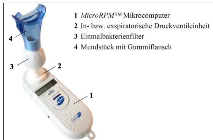
**Abb. 2:** Atemdruckmessgerät *MicroRPM™* von *CareFusion*
