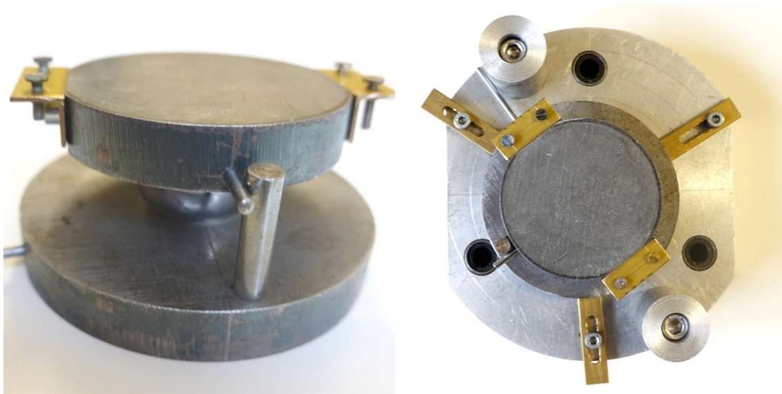
Abb. 9: Auf einer Stahlkugel gelagerte Halterung für den Flächendrucksensor (Tekscan 5051) mit Positionierungs- und Arretierungsmechanismus einzeln (links) und von oben auf Basisplatte (rechts).
