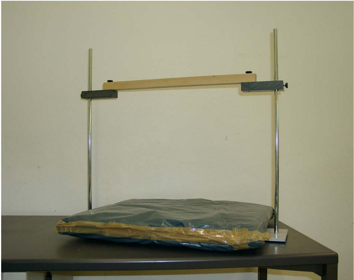
Abbildung B.8: Balkengang-Apparatur
