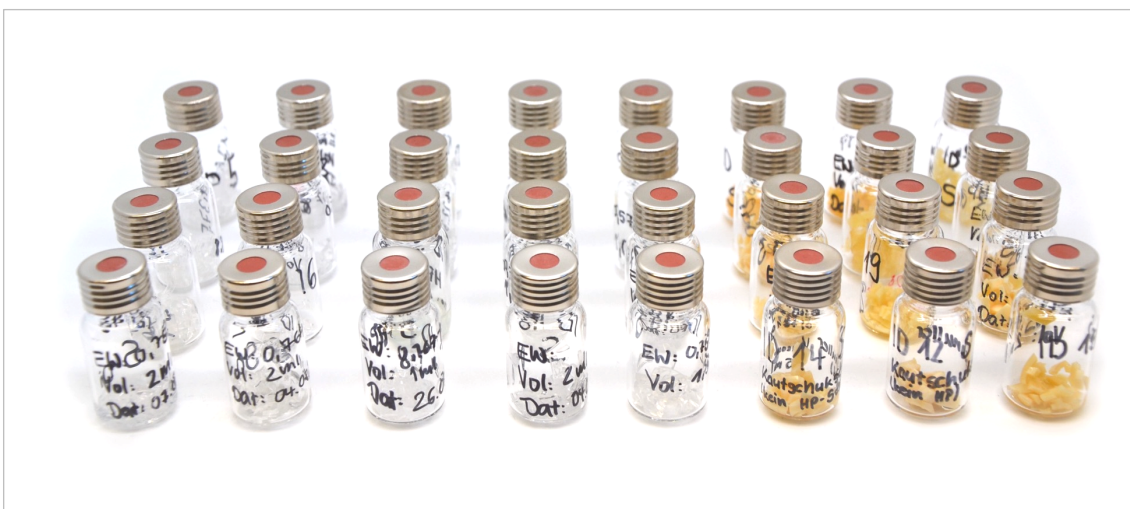
1.8 Migrationsproben der Saugeranteile aus Silikon und Kautschuk
