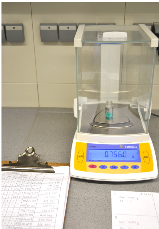
1.3 Einwaage mit Analysenwaage
