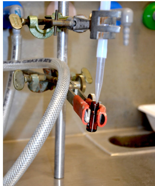
Abb. 4.7: Einengen unter Stickstoff-(N 2 )-Strom
