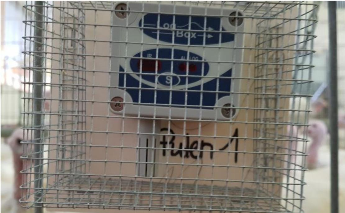
Abbildung 8: Datenlogger im Abteil angebracht auf Kopfhöhe der Tiere. Zum Schutz des Messgerätes wurde ein Drahtgitter davorgesetzt
