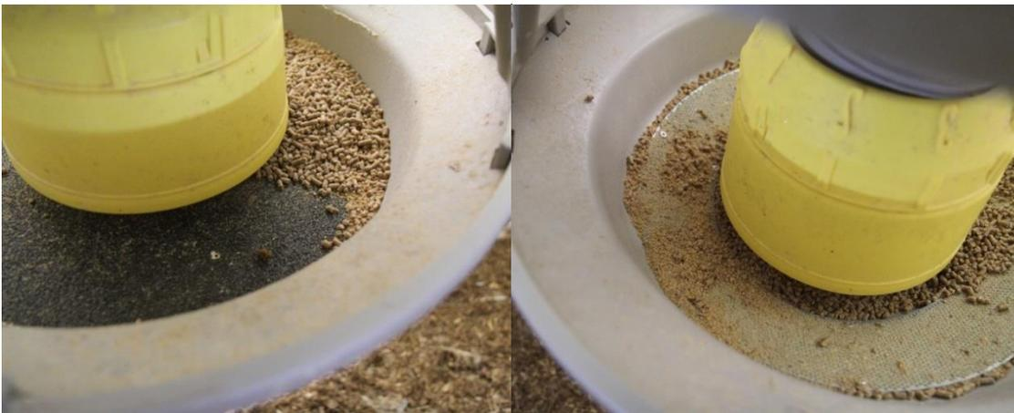
Abbildung 4: Die zwei Bluntingscheiben im Vergleich. Links die Estrichschleifscheibe, rechts die Metallgitterscheibe
