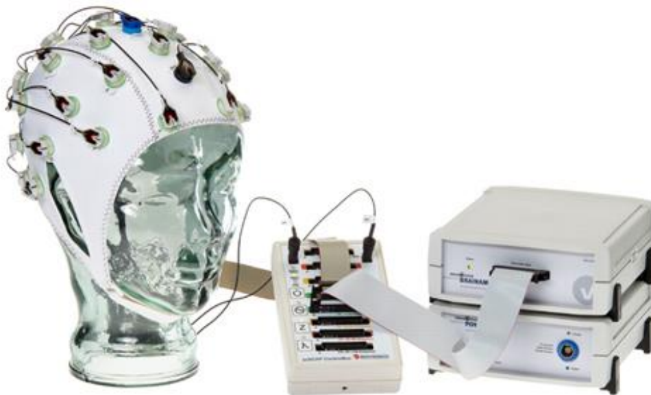
Abbildung 9: actiCap Haube der Firma Brain Products mit angeschlossenem Elektrodenbaum, Controlbox und Verstärker, Quelle: https://www.bionic.es/marca/acticap/ , aufgerufen am 12.01.2020
