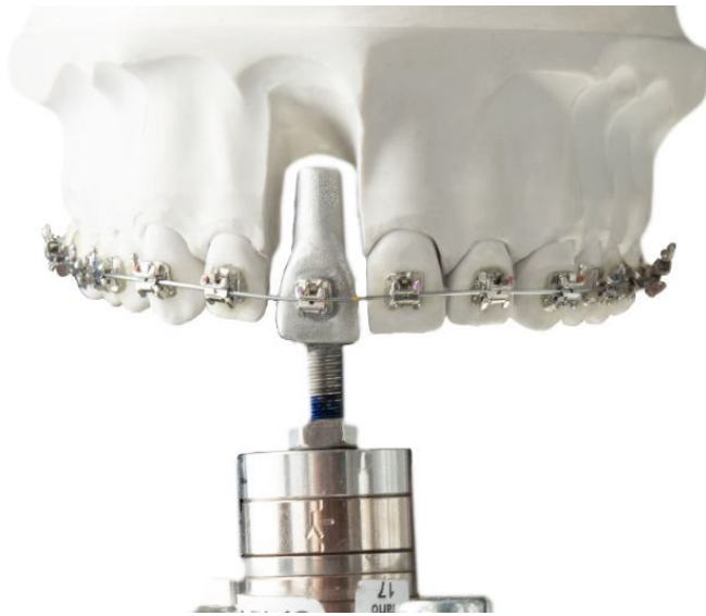
Abbildung 35: Intrudierte Zahnstellung nach aktivierter Kraftsteuerung am Beispiel eines Biostarter .012“ Bogens ohne Stufenbiegung (Forestadent, Deutschland). Erkennbar ist die Diskrepanz der Schneidekanten der Inzisivi 11 und 21. Der Zahn 11 steht leicht extrudiert, der Bogen konnte trotz aktivierter Kraftsteuerung den Zahn nicht vollständig in die physiologische Ausgangsposition intrudieren.
