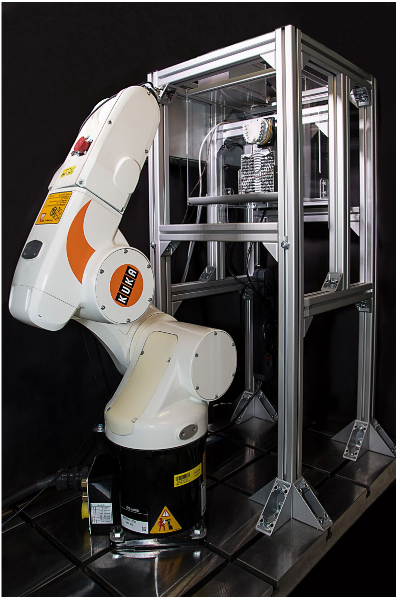
Abbildung 7: Versuchsstand: abgebildet ist der KUKA KR 5-sixx R650 Industrieroboter (KUKA Roboter GmbH, Deutschland) und das Modell als KAVO Typodont (Kavo Dental GmbH, Deutschland) in der Thermokammer. Der Aufbau ist fest mit einer Ankerplatte verschraubt. Nicht dargestellt sind Sensor, Flansch und Zahn, Computer und die zu untersuchenden Bögen.
