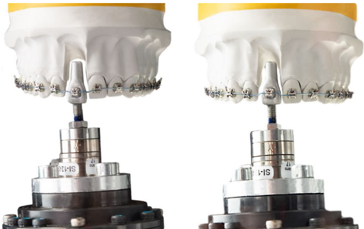
Abbildung 9: Extrudierte Zahnfehlstellung (linkes Bild) und intrudierte Situation (rechtes Bild) nach aktivierter Kraftsteuerung am Beispiel eines Sentalloy .012 Nickel-Titan Bogens (Dentsply Sirona, USA) mit Stufenbiegung.
