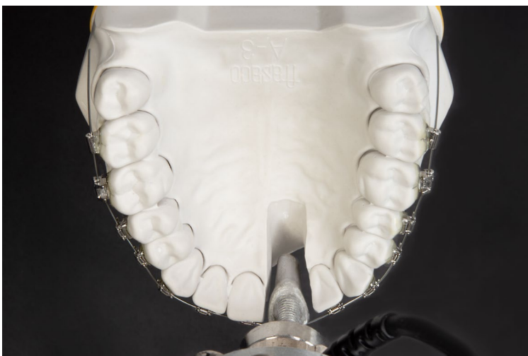
Abbildung 16: In Gips überführtes Modell des Kavo Typodonten (Kavo Dental GmbH, Deutschland) mit beklebten Brackets und eingespanntem Bogen. Der zu untersuchende Frontzahn 11 ist in NEM überführt und am Sensor fixiert.
