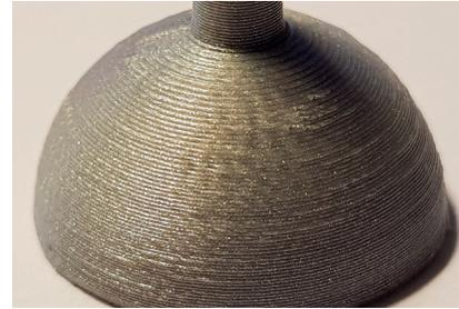
4 | Bei genauerer Betrachtung sind die einzelnen Druckschichten der optisch vergrößerten Halbkugel deutlich zu erkennen
