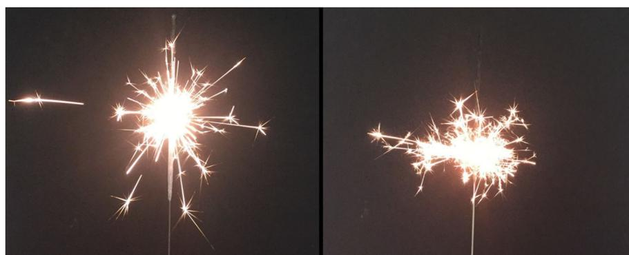
Abb. 6: Abbrennen einer selbst hergestellten Wunderkerze mit dem Oxidationsmittel Strontiumnitrat (links) sowie einer gekauften Wunderkerze mit dem Oxidationsmittel Bariumnitrat (rechts)
