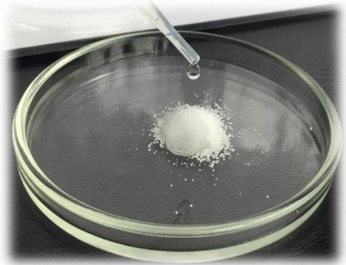
Abb. 2: Wasser wird zu der Mischung aus Natriumhydrogencarbonat und Zitronensäure gegeben
