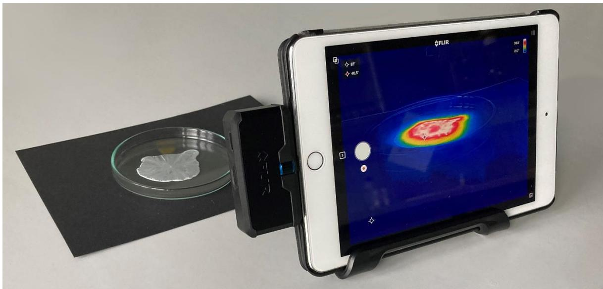
Abb. 10: Nach Zugabe eines Impfkristalls erstarrt die unterkühlte Schmelze unter Wärmeentwicklung (eigene Aufnahme).
