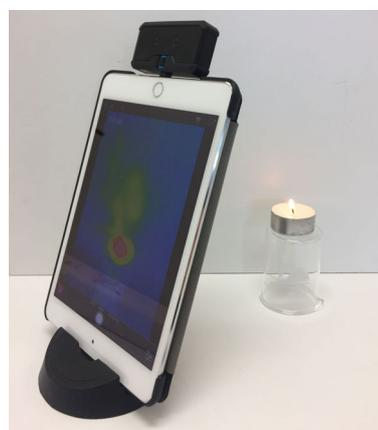
**Abb. 4:** Die Wärmebildkamera „FLIR One“ in Kombination mit einem iPad.
