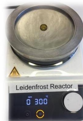
Abb. 1: Leidenfrosttropfen auf dem Leidenfrostreaktor
