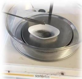
Abb. 1: Abwiegen von Eisenpulver in einem Wägeschiffchen
