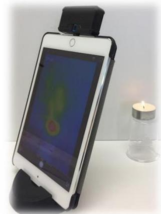
Abb. 1: „FLIR“-Wärmebildkamera auf iPad
