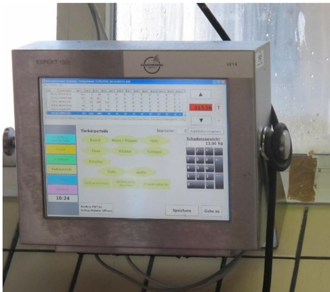
Abbildung 1: Touchscreen-Terminal mit der QualiLine Hard- und Software ©Fleischprüfing Bayern e.V.
