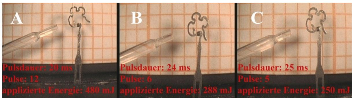
Abbildung 23: Abhängigkeit des Prothesenschlusses von der Pulsdauer bei einer konstanten Leistung von 2 W. A: Inkompletter Prothesenschluss. B: Kompletter Prothesenschluss. C: Kompletter Prothesenschluss.
