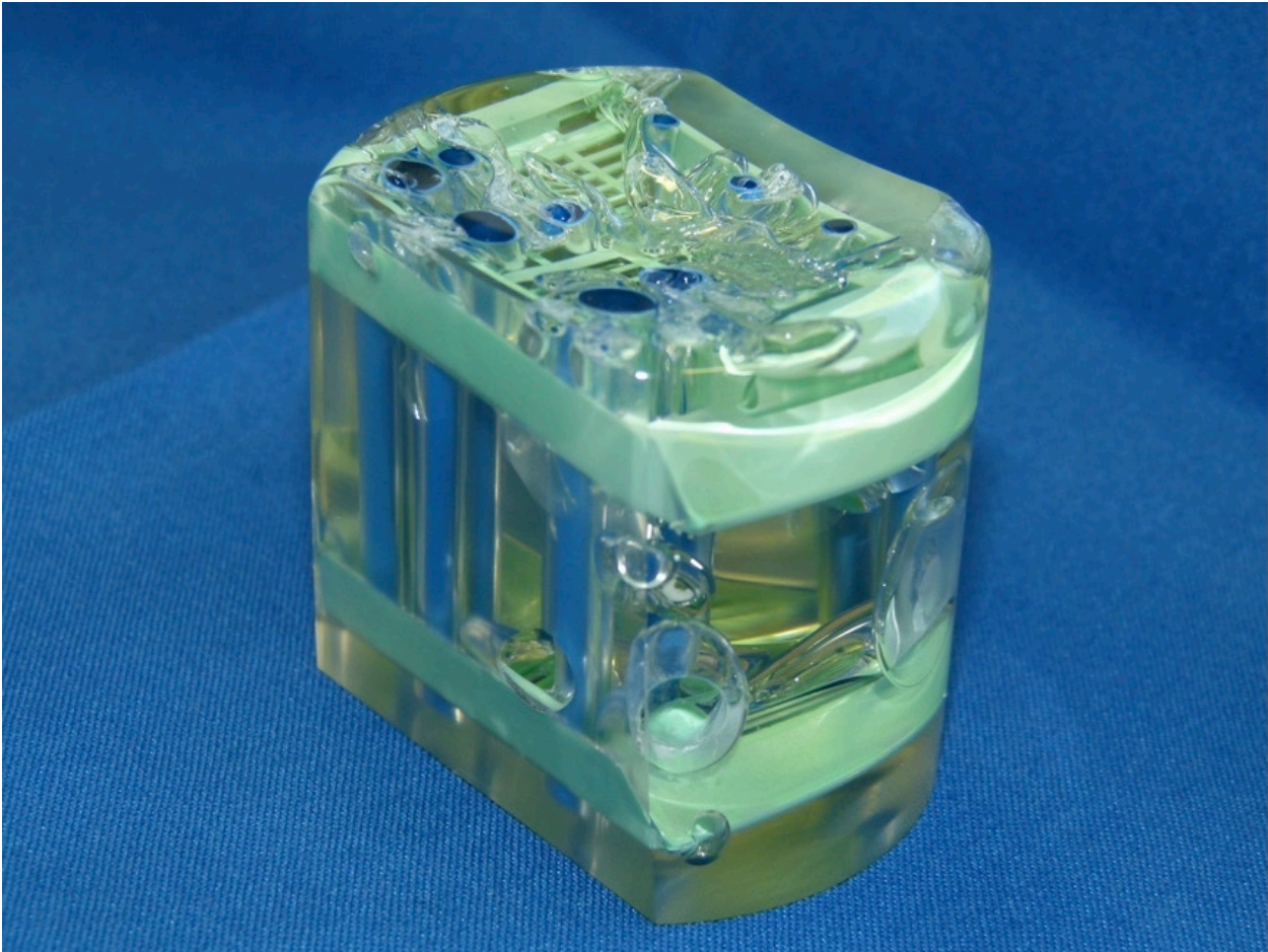
Abbildung 14: Hier sieht man die in das Kunstharz Methylmetacrylat (Technovit 9100, Kulzer&Co, Werheim, Deutschland) eingebetteten Katheter während des Aushärtungsprozesses über 48 Stunden. Das Bild stammt aus dem Labor des UMG Göttingen.
