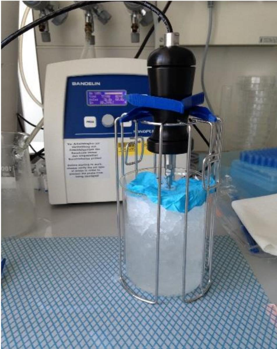
*Abbildung 8: Versuchsaufbau der Schallhomogenisierung: Zu sehen sind das Ultraschallgerät mit seiner Bedienungseinheit im Hintergrund und der an einer Haltevorrichtung fixierte schwarze Griff der Schallspitze. Das aktive metallene Ende der Schallspitze ragt in das Eppendorfgefäß. Dieses steckt in der perforierten Kofferdam-Membran und ragt so in das Eis im Becherglas darunter*
