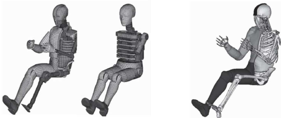
Abbildung 1 – Von links nach rechts: Finite-Elemente (Abkürzung: FE) Modelle des ATD HYBRID III für frontale Belastung, des ATD SID II für seitliche Belastung und des THUMS™-Menschmodells [69]
