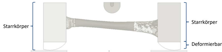
Abbildung 16 – Skizze starrer vs. deformierbarer Versuchsaufbau
