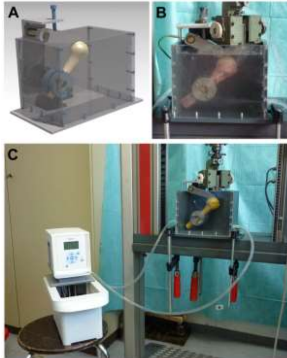
Abbildung 18: (A) Spezieller Wassertank aus Acrylglas und PVC mit integrierter Humerusfixierung aus Edelstahl in 3D CAD Modell. (B) Wassertank mit befestigtem Humeruspräparat. (C) Versuchsaufbau an der Universalprüfmaschine mit Wassertank und Thermostat 38 .
