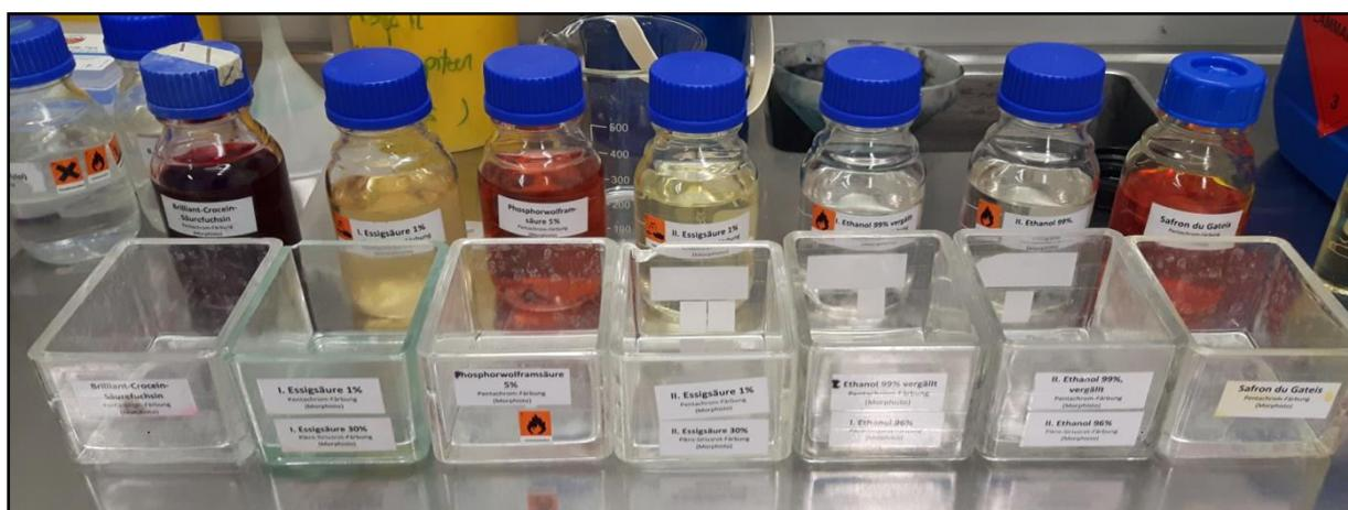
**Abb. 4.11:** Vorbereitung der Färbeküvetten: Zu erkennen sind die Glasküvetten, in denen die Färbung stattfindet. Hinter den Glasküvetten stehen die Flaschen mit den jeweiligen Färbedetergenzien, im Rahmen der Pentachrom-Färbung handelt es sich hierbei um die Schritte 19.-25. (vollständiges Färbeprotokoll im Anhang, Kap. 9.2)
