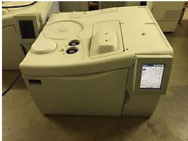
Abbildung 8; GC HP 5890 (Clarus 500) (Fa. Perkin Elmer)
