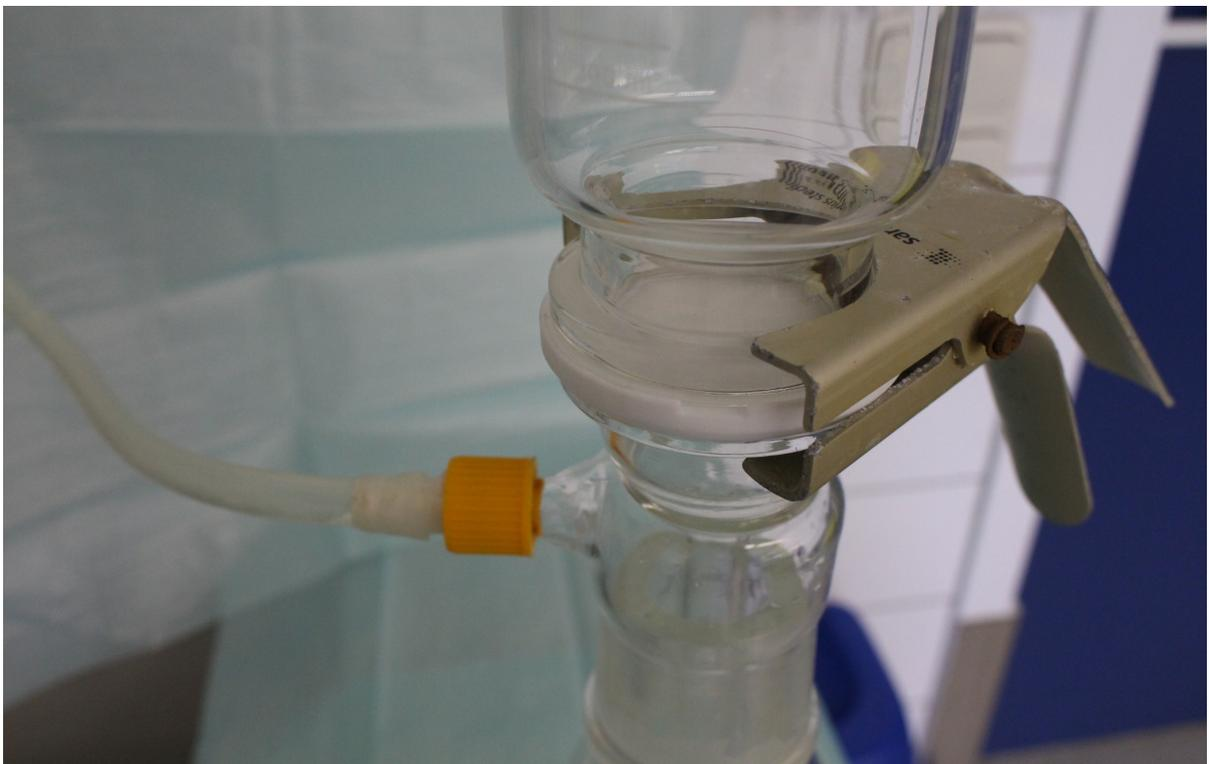
Abb. 12: Filter mit Filterauflage im Büchnertrichter
