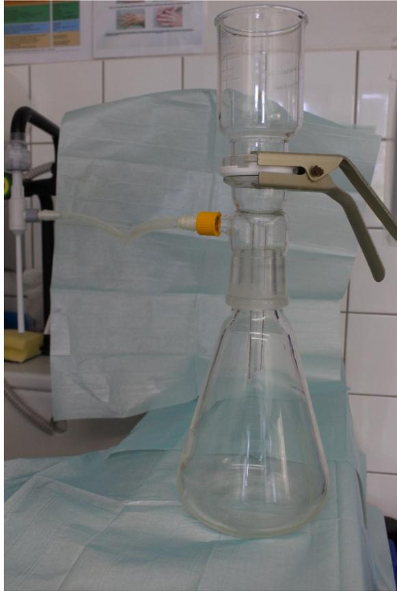
Abb. 11: Aufbau des Büchnertrichters
