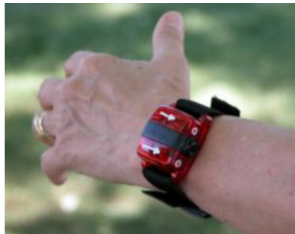
Abb. 5: Korrektes Tragen des Akzelerometers nachts; Sensor am nicht-dominanten Handgelenk; Abbildung mit freundlicher Genehmigung des Helmholtzzentrums München
