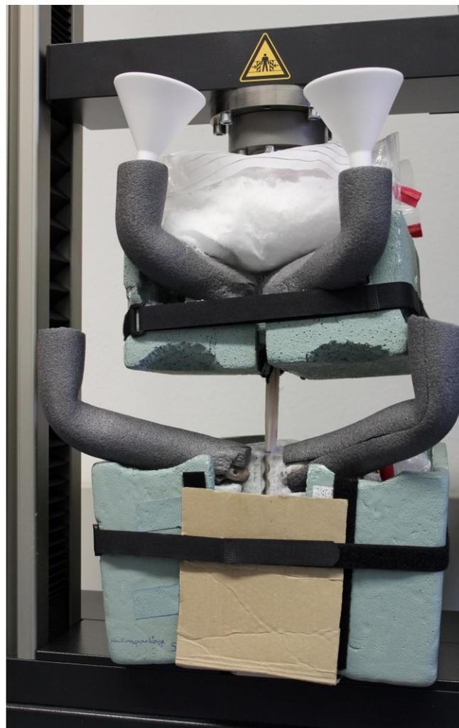
**Abbildung 17:** Versuchsaufbau mit eingespannter tiefen Beugesehne.
