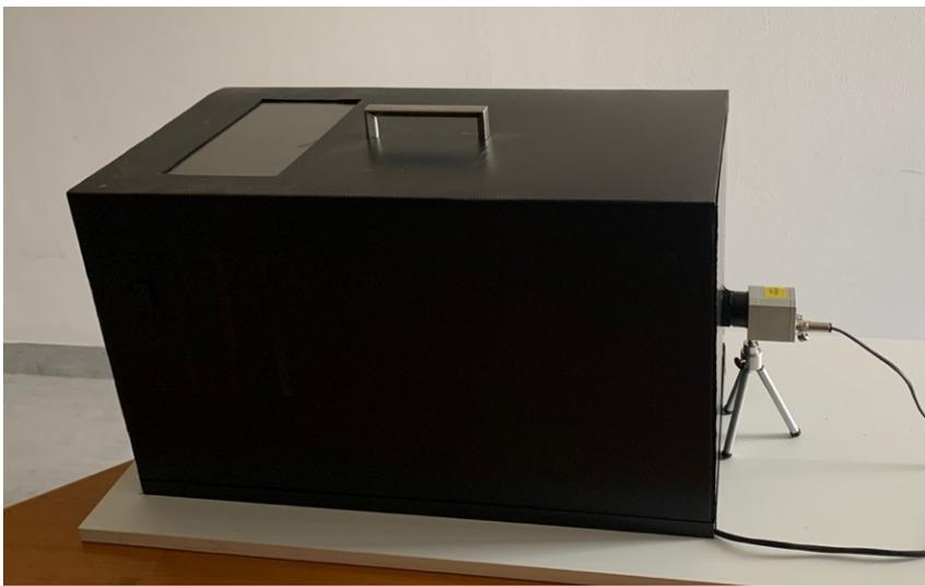
*Abb. 2: Mit schwarzer Folie ausgekleidete Versuchsbox aus Plexiglas*
