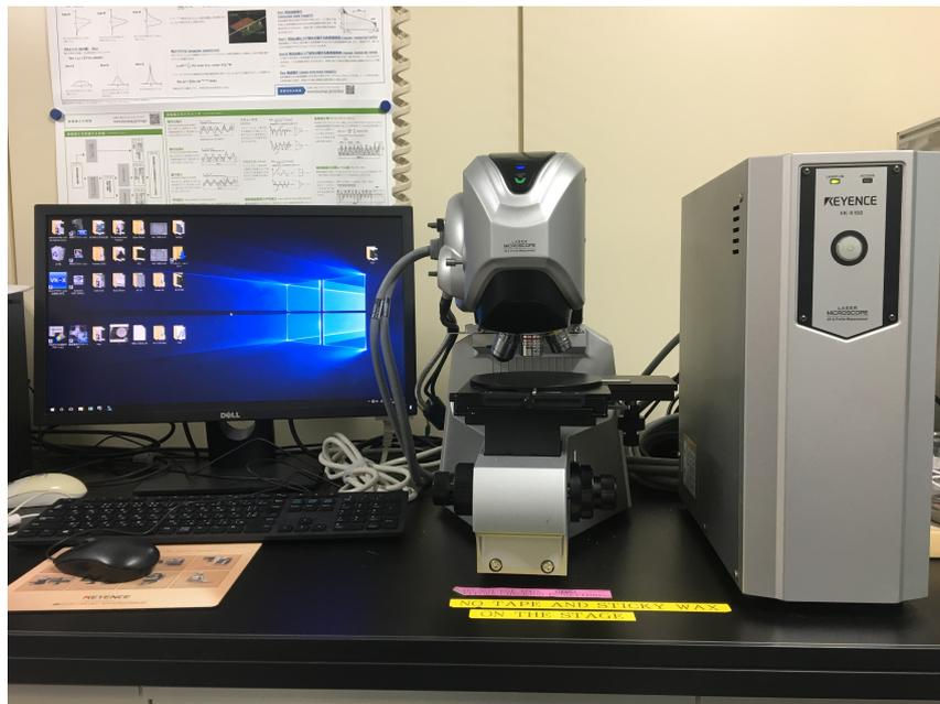
Abbildung 4.5: Konfokales 3D-Laserscanning-Mikroskop, VK-X150, Keyence
