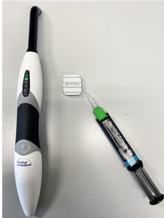
Abbildung 4.11: Probenherstellung mit Variolink Esthetic und Bluephase Style zur Polymerisation
