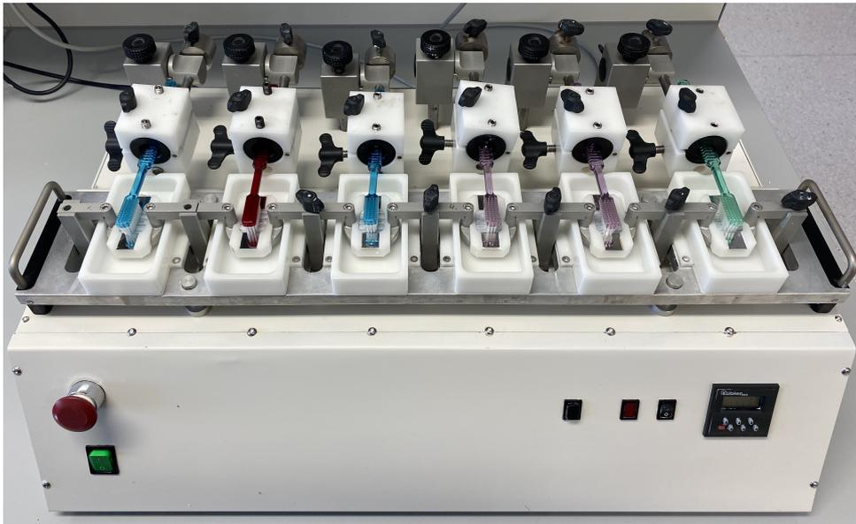
Abbildung 4.9: Zahnbürst-Prüfmaschine-linear LR 1 mit fertig installierten Proben und Zahnbürsten
