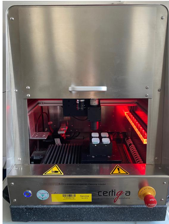
Abbildung 4.12: 3D-Surface Scan KF-30 mit vier zu scannenden Prüfkörpern
