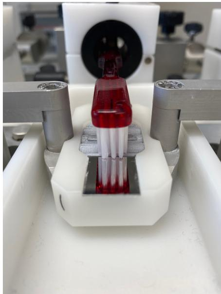
Abbildung 4.10: Positionierung des Bürstenkopfes auf dem Prüfkörper
