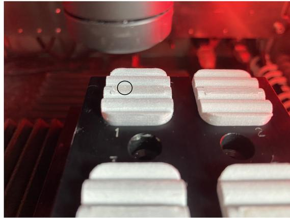
Abbildung 4.14: Messpunkt (schwarzer Kreis) des 3D-Scanners auf der Materialoberfläche beim Erfassen der Oberfläche
