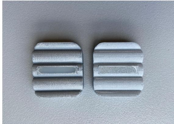
Abbildung 4.13: Oberfläche des Prüfkörpers, links ohne und rechts mit Entspiegelungsspray
