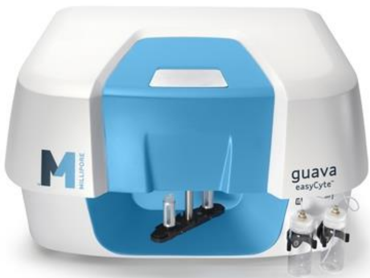
Abbildung 13: Das verwendete Durchflusszytometer von Merck Millipore. Angeschlossen wurde das Gerät an einen PC, auf dem die InCyte Software installiert war; https://www.selectscience.net/products/guava-easycyte-8ht-benchtop-flow-cytometer/?prodID=84548
