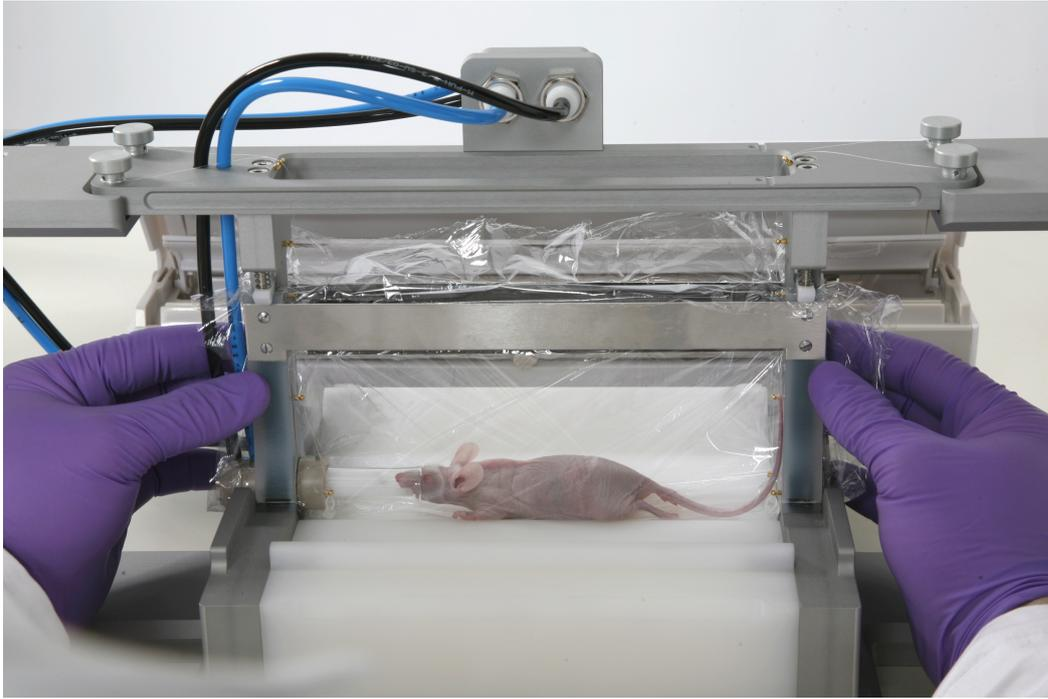
**Abb. 7: Das Versuchstier wird vor der Untersuchung unter Anästhesie in der Halterung platziert und mit Polyethylenfolie umwickelt. (mit Genehmigung der iThera Medical GmbH).**
